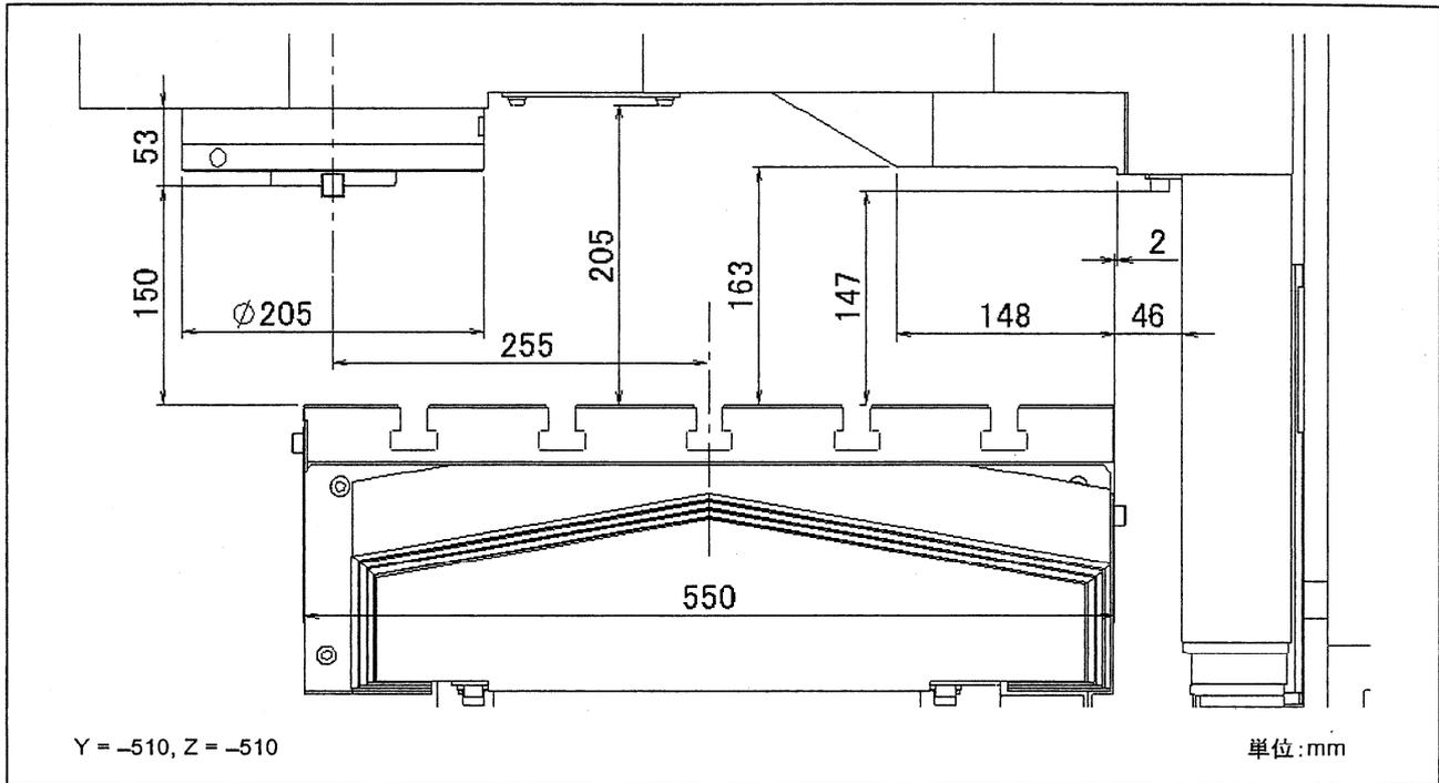
Fig. 1-17 カバー干渉図(VCN-510C:Y = -510, Z = -510)
