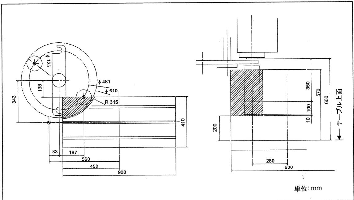
Fig. 1-9 ワーク干渉図 (VCN-410A/410A-HS)
