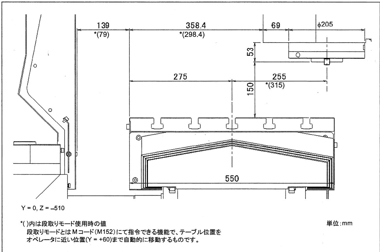
Fig. 1-18 カバー干渉図(VCN-510C:Y = 0, Z = -510)
