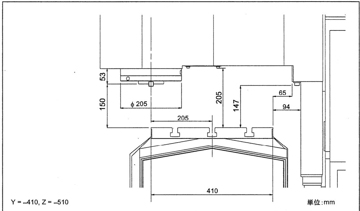
Fig. 1-15 カバー干渉図(VCN-410A/410B:Y = -410, Z = -510)
