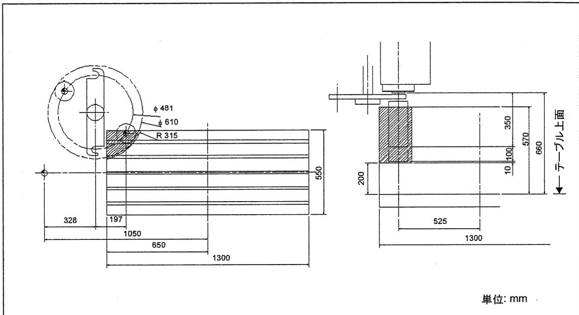
Fig. 1-11 ワーク干渉図(VCN-510C/510C-HS)
