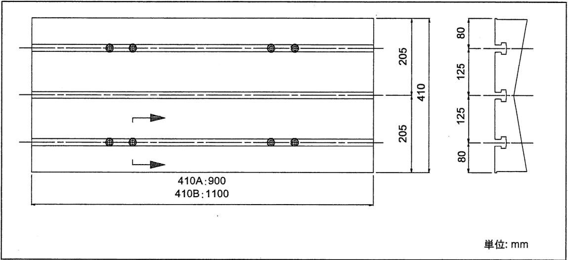
Fig. 1-4 テーブル寸法図 (VCN-410A/410B)
