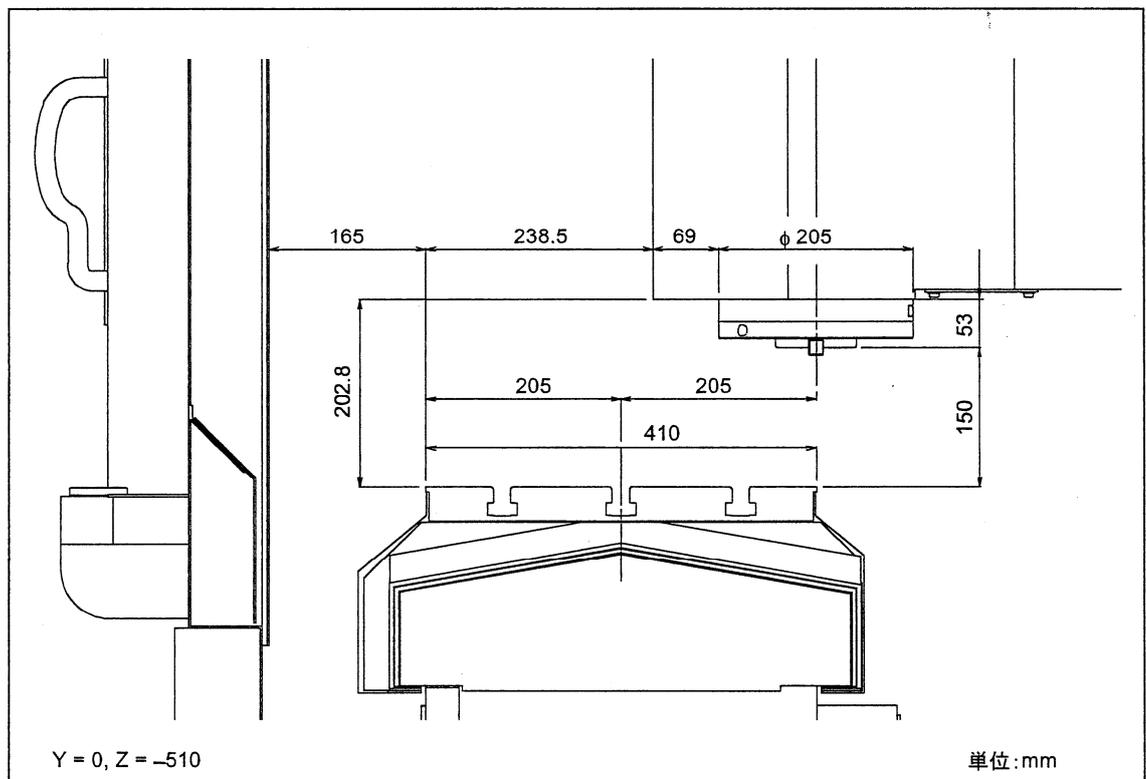
Fig. 1-16 カバー干渉図(VCN-410A/410B:Y = 0, Z = -510)
