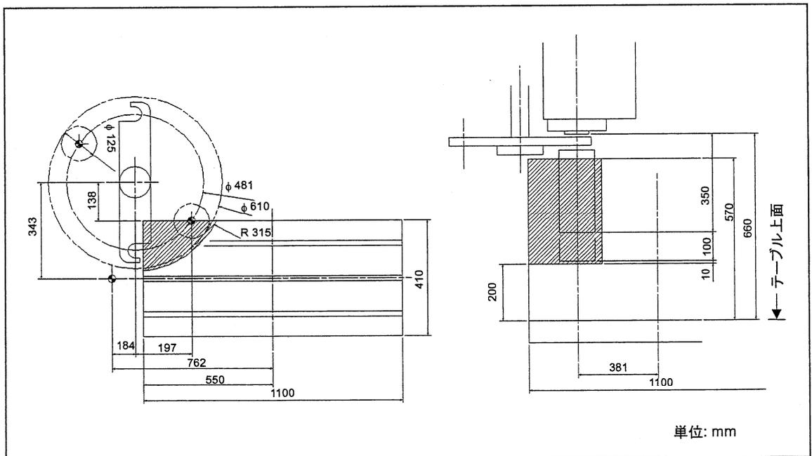
Fig. 1-10 ワーク干渉図 (VCN-410B/410B-HS)
