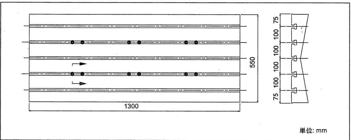
Fig. 1-5 テーブル寸法図 (VCN-510C)
